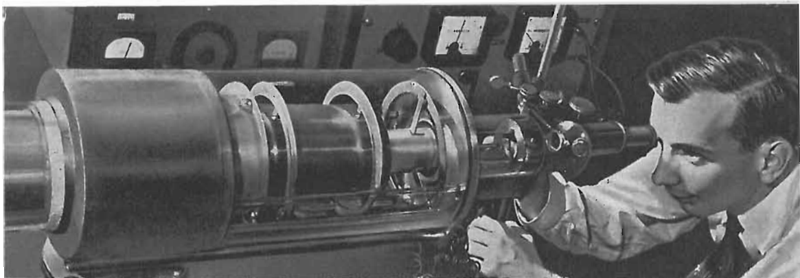
Modello di amplificatore attraversato da elettroni accelerati fino a ottomila chilometri il secondo
